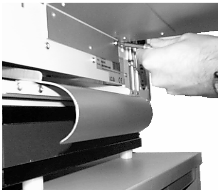
Abb. 2.5.f Oberes Papierführungsblech festschrauben
