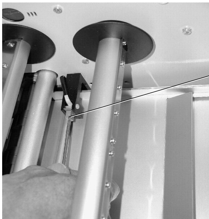
Abb.8.2.a: Neueinstellung des Sensors mit einem Schraubendreher
